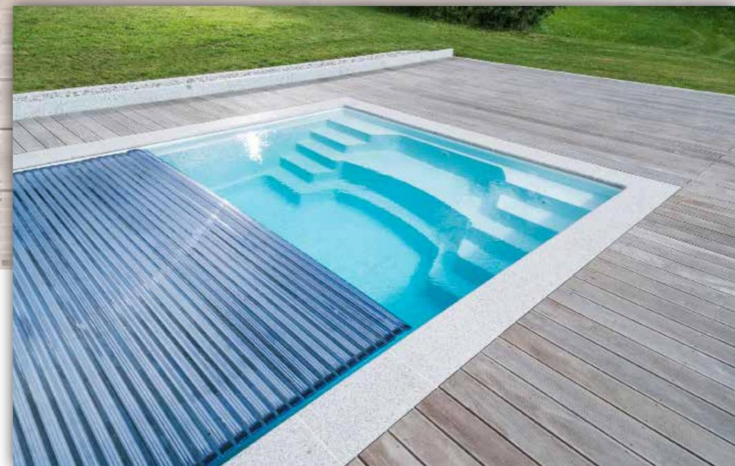
Die Rollladenabdeckung hält das Wasser warm und bietet Schutz vor Verunreinigungen. Das sorgt für Sicherheit – und man kann damit wertvolle Energie sparen.
