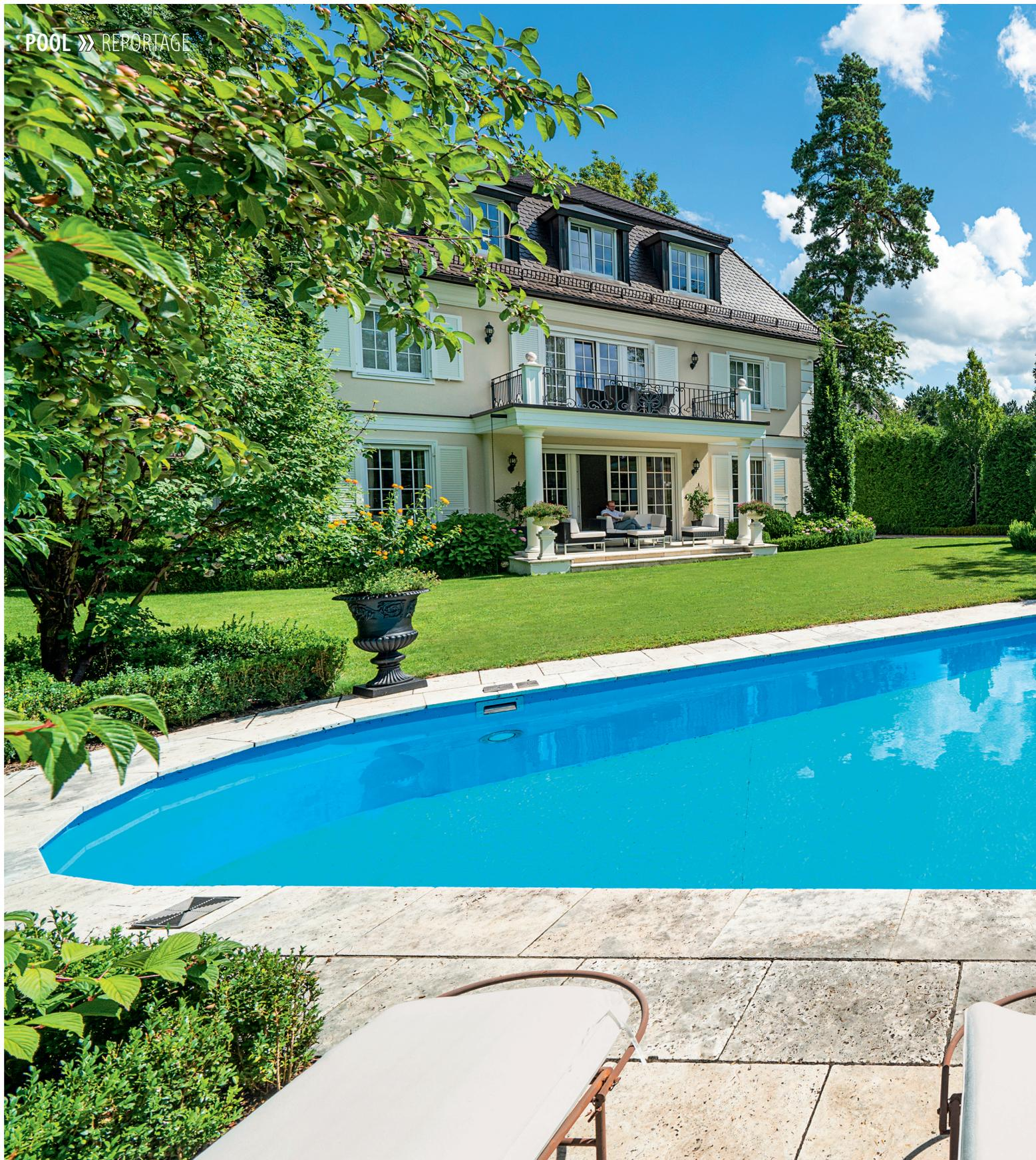
Ein Freiformbecken, das an einen großen blauen Wassertropfen erinnert. Das war der Wunsch der Bauherren an den Schwimmbadbauer Thamm. Er realisierte den Swimmingpool als betoniertes Skimmerbecken mit blauer Folienauskleidung.
